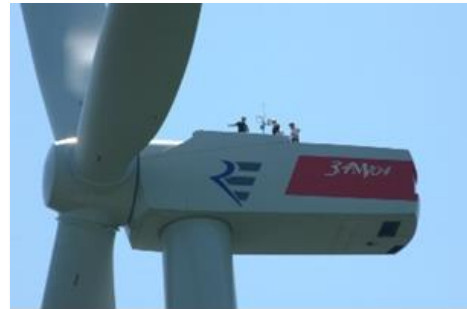
Senvion 3.4M104 3,4 MW, Ø Rotor 104 m
